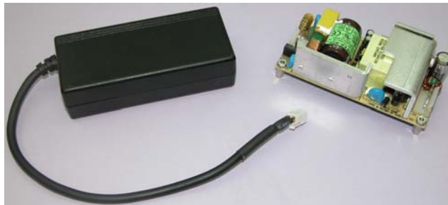
Fig. 6.- USMP supplied 5VDC power modules.
